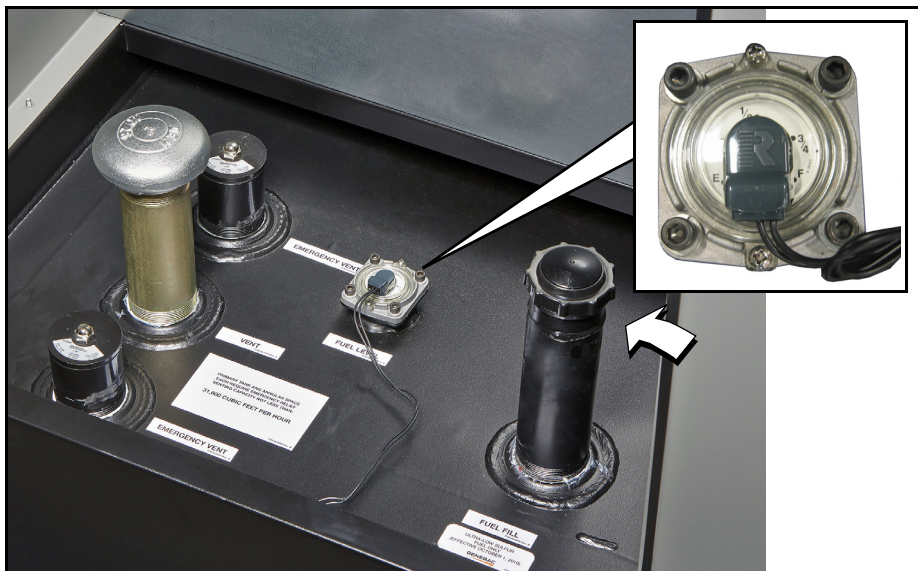
Рисунок 5-7. Проверьте показания указателя уровня топлива и наполните бак
