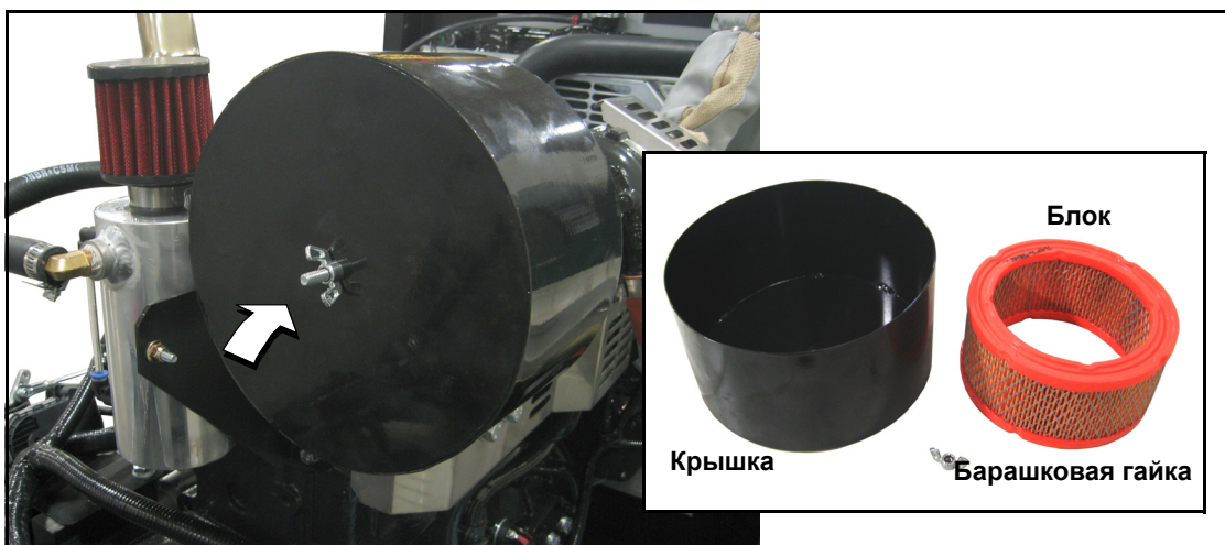
Рисунок 5-14. Крышка воздухоочистителя и блок фильтра
