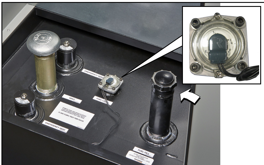
Figura 5-7. Comprobación de nivel y llenado de combustible
