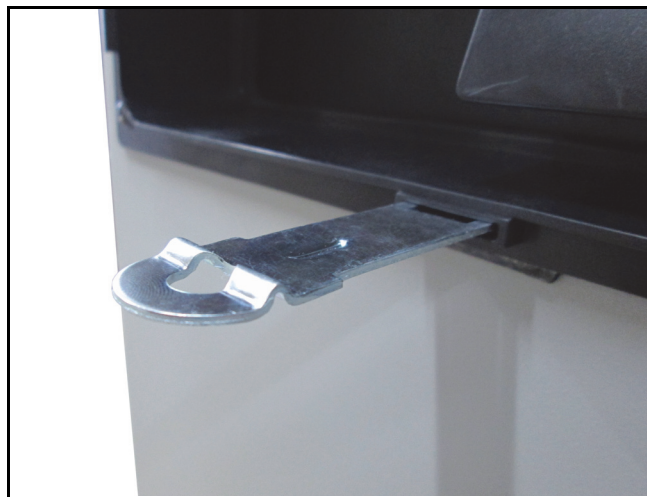
Figura 3-7. Instale a trava da janela de visualização
